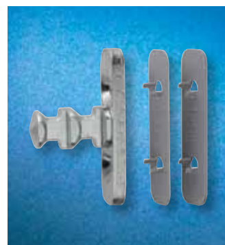
Bolce ryglujące z mikrowentylacją, umożliwiają powstanie szczeliny pomiędzy skrzydłem a ramą.
