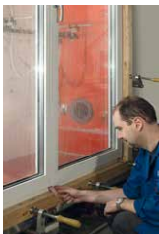
Banc d'essais AEV pour perméabilité à l'air, étanchéité à l'eau et résistance au vent
