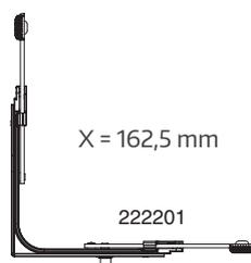
1. Bohrlehre Art. Nr. 227350 **(A)** für rechte und linke Flügel im Abstand X von der Rahmenfalzecke unten einlegen und mit Bohrer **(B)** Ø 8 alle Bohrungen max. 6 mm tief setzen (Maß X für Falzluft 12 mm).
