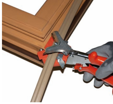
Dichting in de juiste positie knippen
