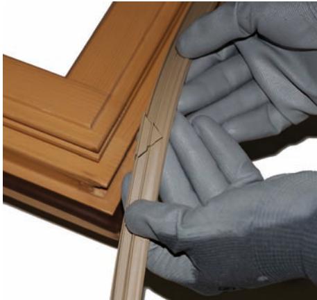
Snij afval verwijderen
