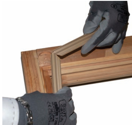
Snijreferenties en messen op juiste wijze positioneren voor de "Y" snede
