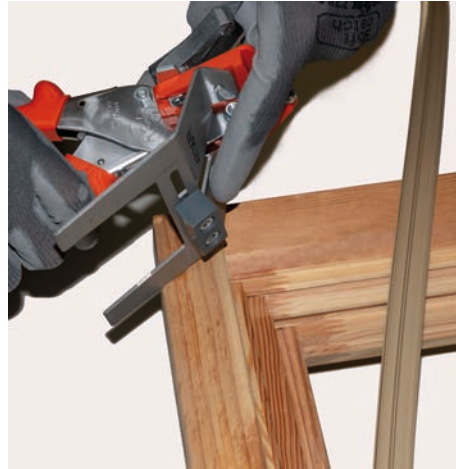
Snijreferenties en messen op juiste wijze positioneren voor de "Y" snede
