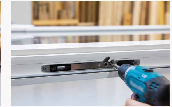
Schritt 3: Verschlusskomponente anschrauben
