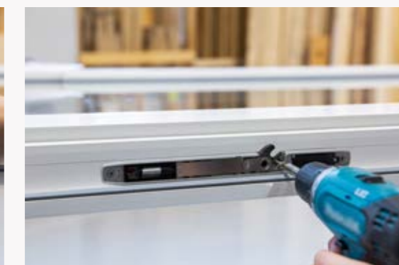
3: Avvitare il componente di chiusura
