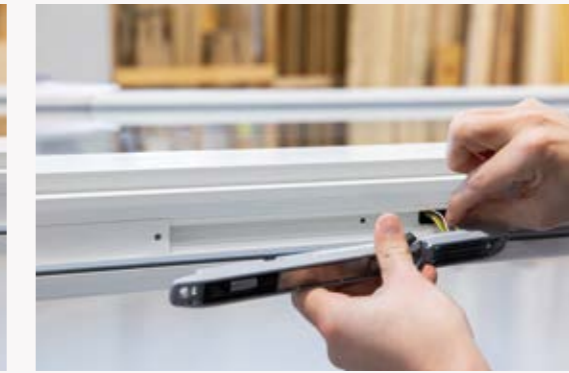
Étape 2 : Fixer le module de fermeture et l'insérer dans la rainure à ferrage
