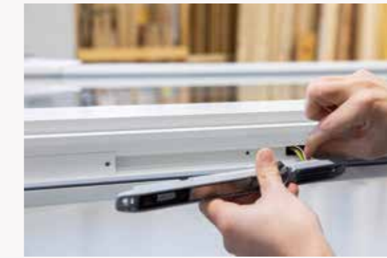
Stap 2: Bevestig het vergrendelingsonderdeel en steek het in de beslaggroef.
