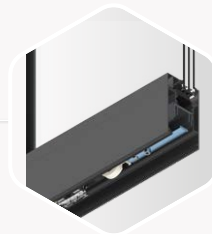
TRINGLE DE LIAISON À L'EXTÉRIEUR DE LA CHAMBRE Fixation par complémentarité de forme et de force : La liaison empêche durablement le frottement du vantail
