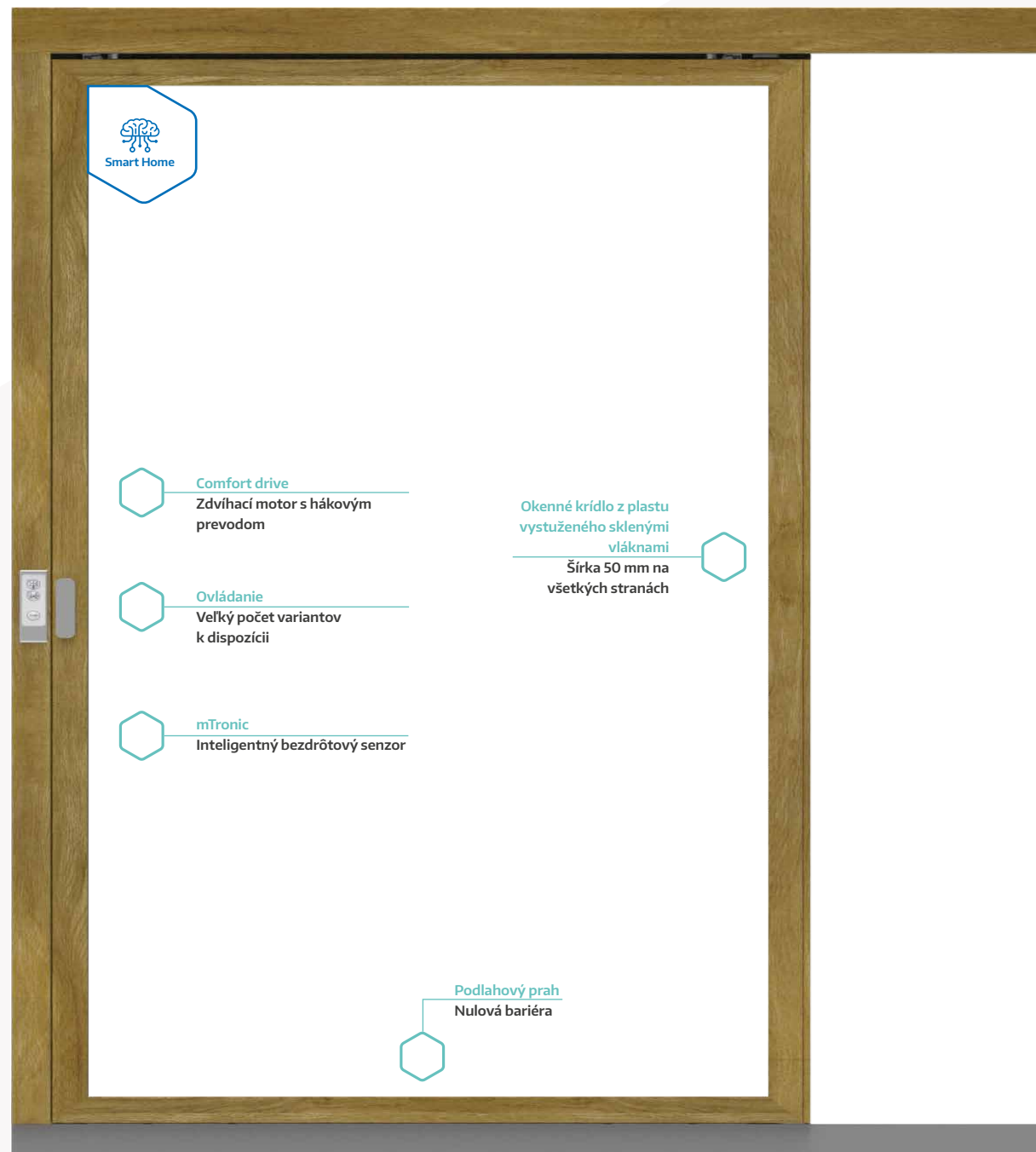
Zdvižno-posuvné dvere, schéma A, motorizované (vnútri drevené, zvonku hliníkové)
