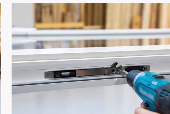
Krok 3: Przykręć moduł ryglujący
