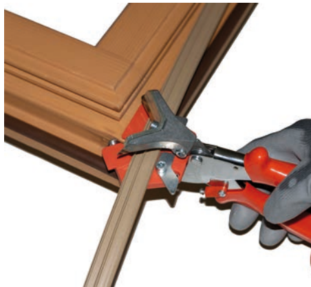
Tagliare la guarnizione nella posizione corretta
