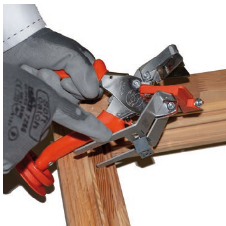
Montare sulla tronchese l'accessorio per telaio
