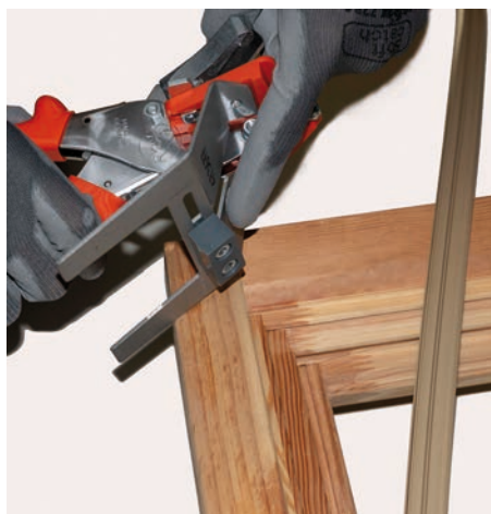
Per la corretta definizione del punto di taglio, regolare il cursore sulla battuta
