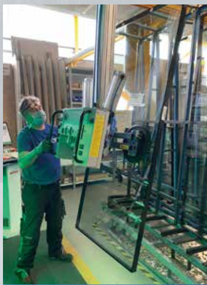
Когда стекло и створка соединяются с рамой, начинается процесс клеивания. Окна и остеклённые двери на пути к клеильной машине
