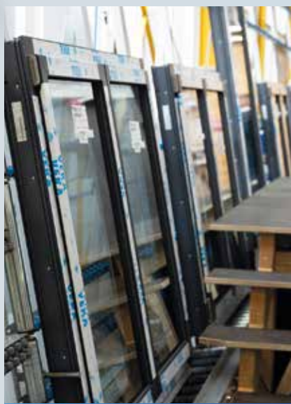
Когда стекло и створка соединяются с рамой, начинается процесс клеивания. Окна и остеклённые двери на пути к клеильной машине
