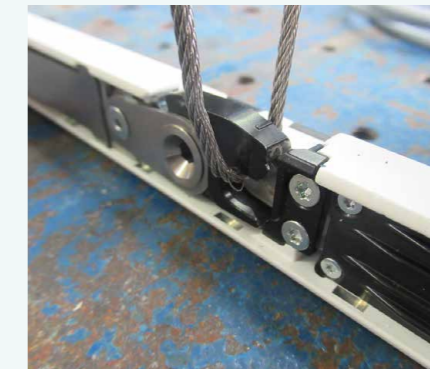
Die Prüflinge während der Durchführung der Dauerfunktions- bzw. Belastungsprüfungen gemäß EN 14846 am IFT Rosenheim.
