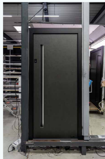
Signature-Tür mit INSTINCT-Verschluss am Teststand. Köster setzt im minimalistischen Türflügel innen wie außen gerne auf Muldengriffe.
