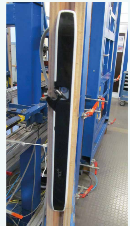
Die Prüflinge während der Durchführung der Dauerfunktions- bzw. Belastungsprüfungen gemäß EN 14846 am IFT Rosenheim.
