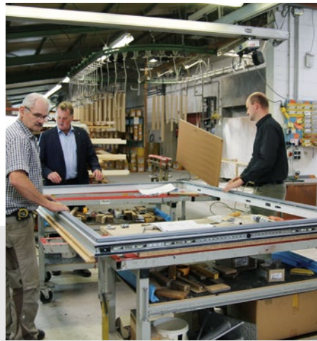
Aufsetzen der Alu-Deckschale
