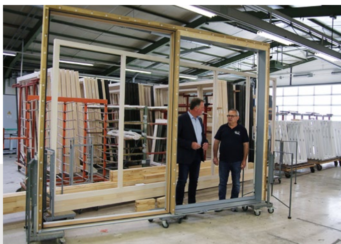
Fast fertiger Flügel. Außen wird noch der Alurahmen aufgeklipst. Hier sieht man, wie der Flügelrahmen rechts im Blendrahmen verschwindet und die Glaslichte gleich der Durchgangslichte ist.
